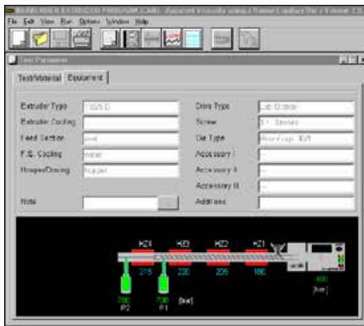
Brabender® Plasti-Corder Lab-Station и измерительный экструдер Кинематическая вязкость, определяемая при помощи круглой капиллярной экструзионной головки
